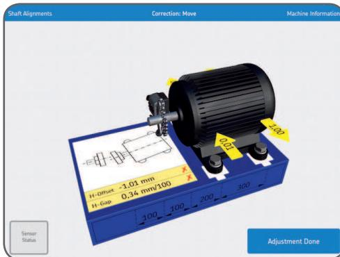
После коррекции, либо если коррекция не требуется, нажмите «Регулировка завершена» (Adjustment Done).
