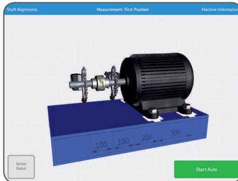
*Когда система определяет достаточность прокручивания вала, который после этого оставался неподвижным в течение короткого времени, автоматически регистрируется 2<sup>-е</sup> положение измерения.*
